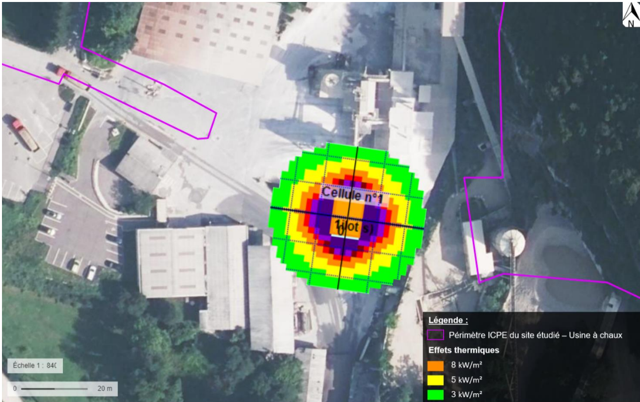
Figure 7 : Effets thermiques de l'incendie d'un stockage de palettes à l'extérieur – Scénario stockage palettes (PhD 12)
