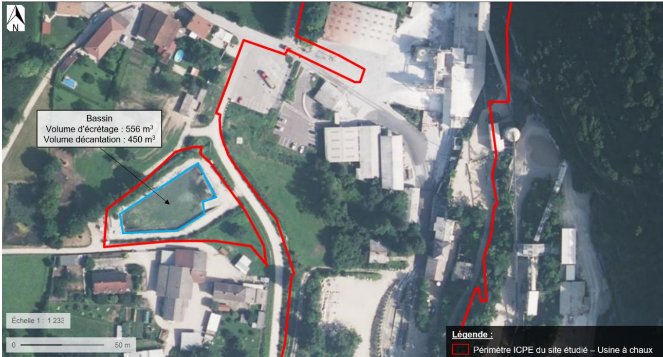
Figure 26 : Bassin de récupération des eaux incendie
