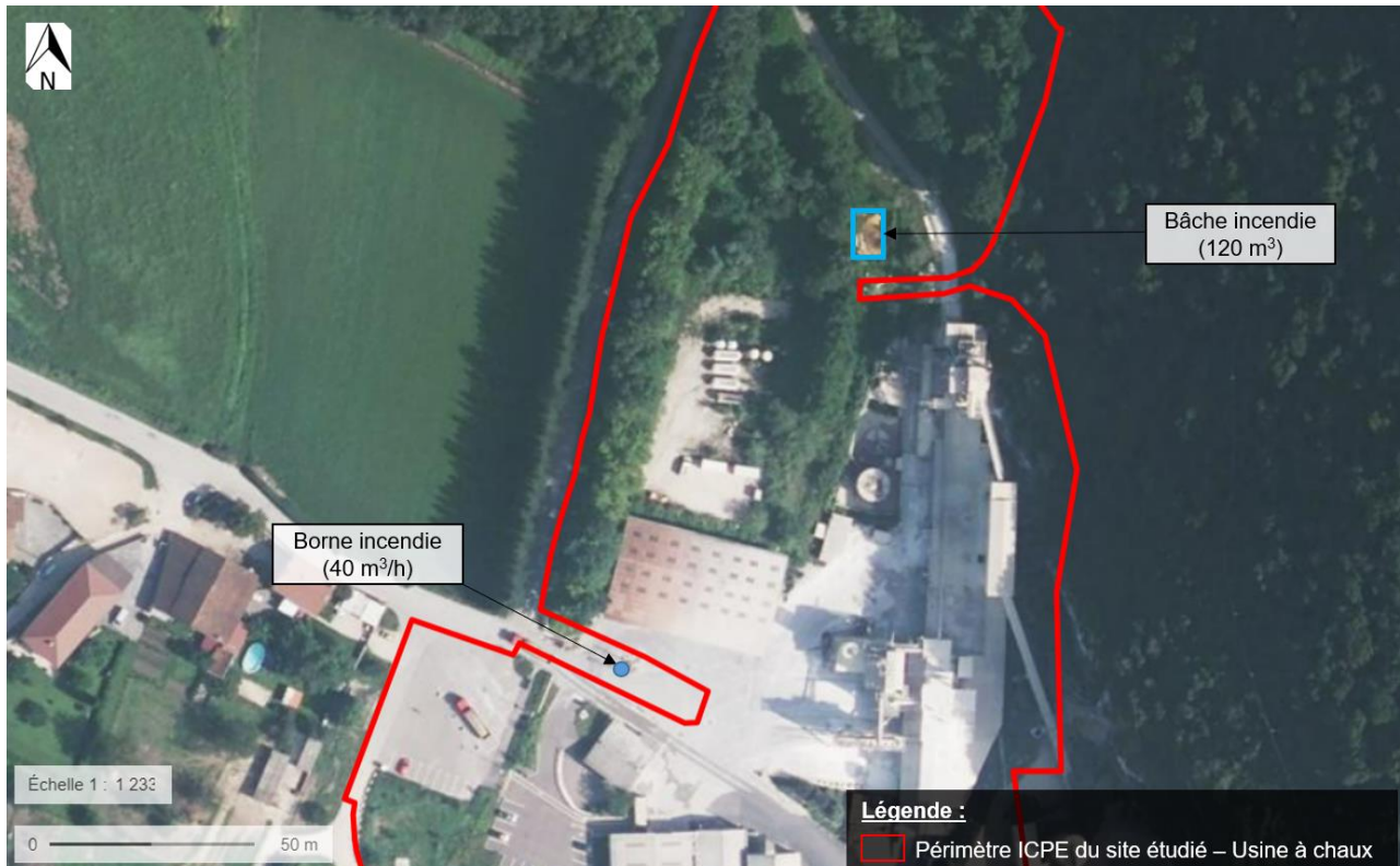
Figure 25 : Borne et bache incendie
