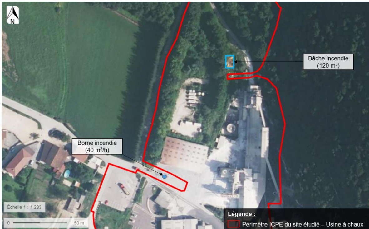
Figure 3 : Borne et bache incendie
