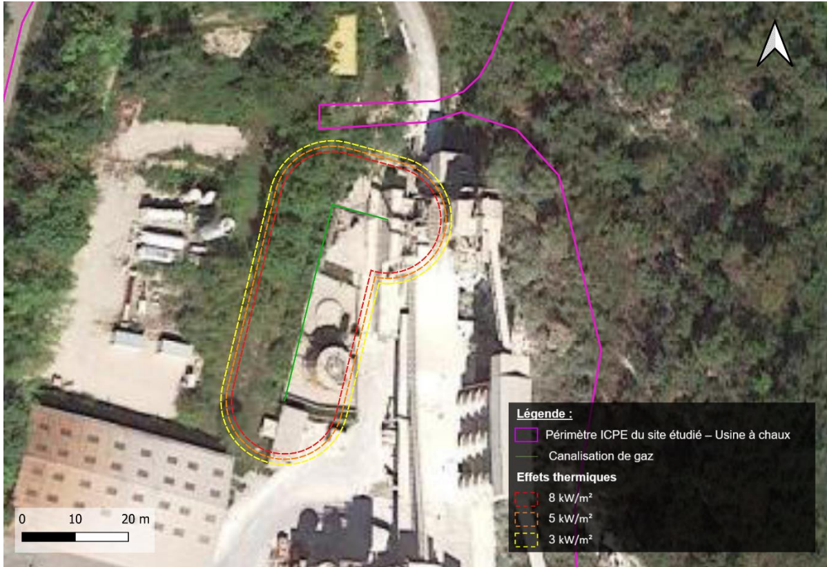
Figure 33 : Résultats des effets thermiques d'un jet enflammé – condition majorante F3 (PhD 18a)
