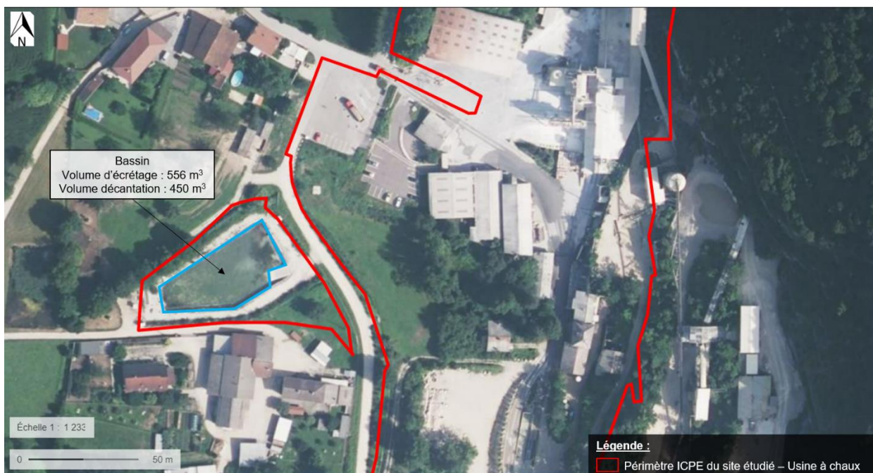
Figure 4 : Bassin de récupération des eaux incendie
