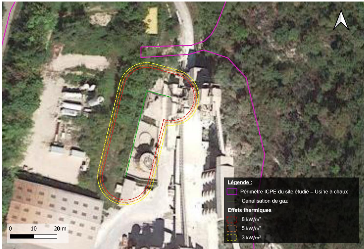
Figure 8 : Résultats des effets thermiques d'un jet enflammé – condition majorante F3 (PhD 17a)
