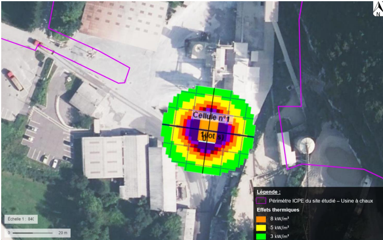
Figure 32 : Effets thermiques de l'incendie d'un stockage de palettes à l'extérieur – Scénario stockage palettes (PhD 12)
